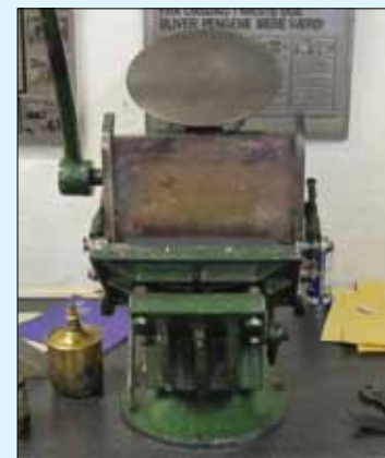
Garnhæftemaskine til hæftning af ark til bøger fra ca. 1936.
