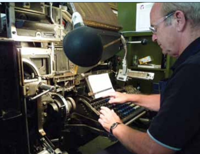
Ombrydning af sider til en bog. Linotype sættemaskine fra ca. 1940.
