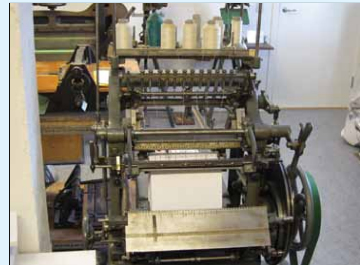
Garnhæftemaskine til hæftning af ark til bøger fra ca. 1936.
